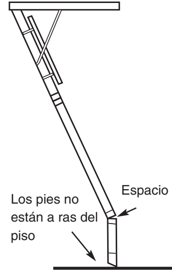
La sección inferior es demasiado corta
